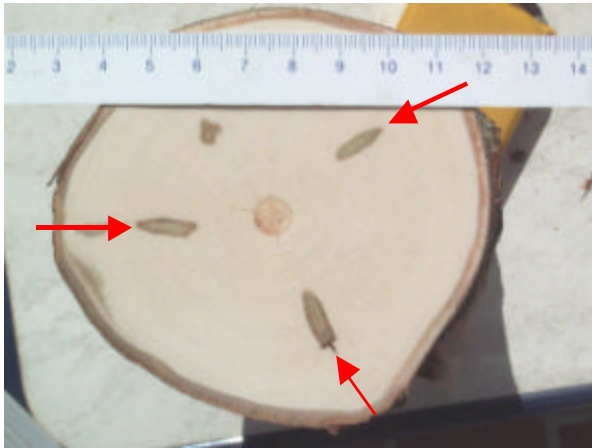
Abb. 4: Stammquerschnitt mit Verfärbungen an drei Injektionsstellen (Probe Wie98-2-b).
